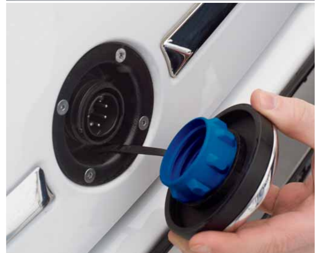
Auf den ersten Blick ein ganz normales Auto: der Micro Vett by Karabag Elektrik (oben). Doch wo sonst Kraftstoff nachgefüllt wird, verbirgt sich eine Ladebuchse (unten).
