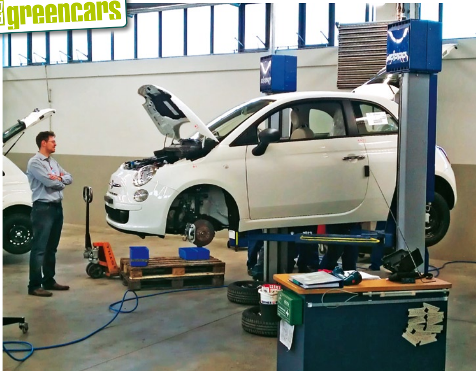
Hier entsteht der Elektro-Fiat new 500 E Karabag kauft die Fiat 500 ein, um sie dann in Hamburg und bei der Firma Mosolf in Kippenheim unter anderem mit Elektromotoren von Linde und Akkus von Dow-Kokam auf Elektroantrieb umzurüsten
