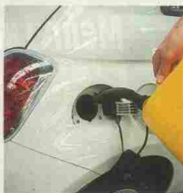
Auf 100 km braucht der Karabag 14 kWh Strom. Die Heizung wird mit Benzin betrieben. Der E-Motor leistet 30 kW
